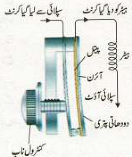
شکل 8.20: دو دھاتی تھرمو سٹیٹ پہلے سے سیٹ کیے گئے نمبر پیچ پر الیکٹریک سرکٹ کو کات دیتا ہے۔
